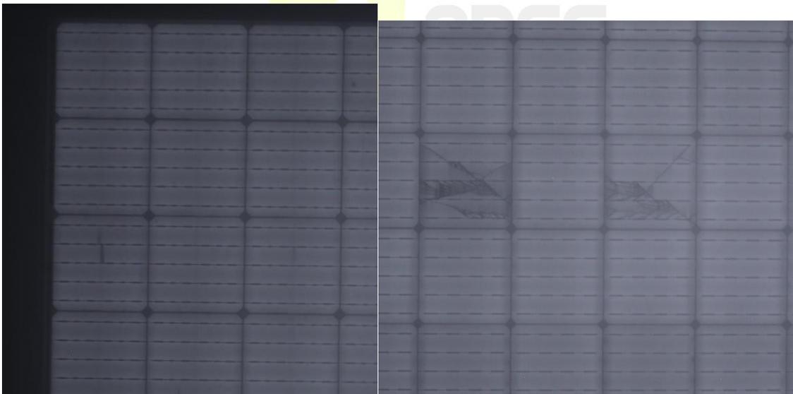
A través de la prueba de electroluminiscencia es posible detectar celdas con defectos de fábrica o daños en el proceso de instalación.
