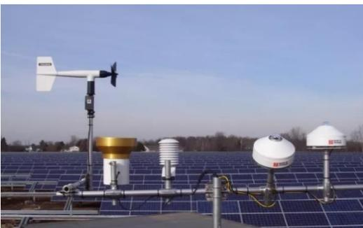
Las estaciones meteorológicas son un componente crítico para la determinación del rendimiento de los Sistemas Fotovoltaico con respecto a las condiciones medio ambientales, la serie de normativas mexicanas NMX-J-643-ANCE, basada en normativa IEC, establece aspectos para la medición de parámetros para el cálculo del rendimiento del Sistema Fotovoltaico a partir de los parámetros que se deben monitorear en las estaciones meteorológicas.
